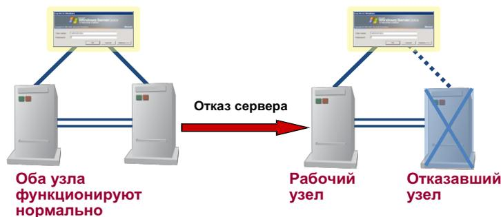
Реализация третьего уровня отказоустойчивости (при выходе из строя вычислительного узла).
