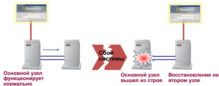
Реализация второго уровня отказоустойчивости (при выходе из строя вычислительного узла).
