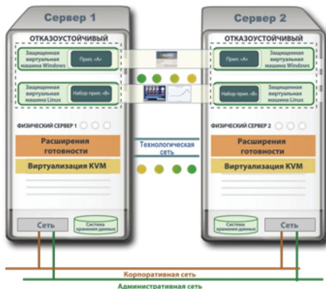
Упрощенная схема вычислительного комплекса повышенной надежности и живучести под управлением ПО Stratus everRun.
