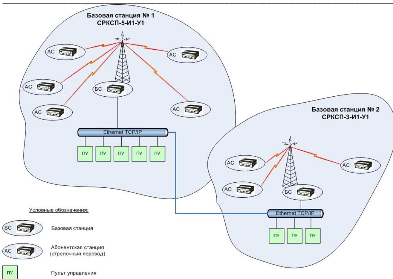
Рис. 4. Общая схема технологической радиосети обмена данными СРКСП.
