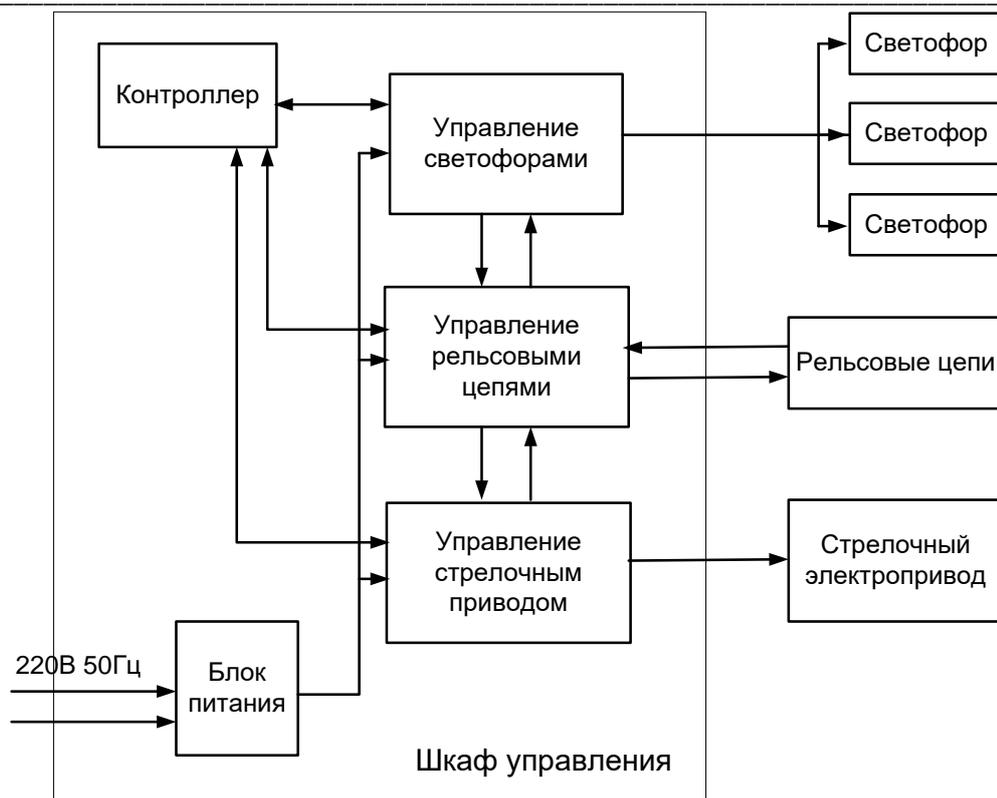
Рис. 2. Функциональная схема шкафа управления СРКСП.
