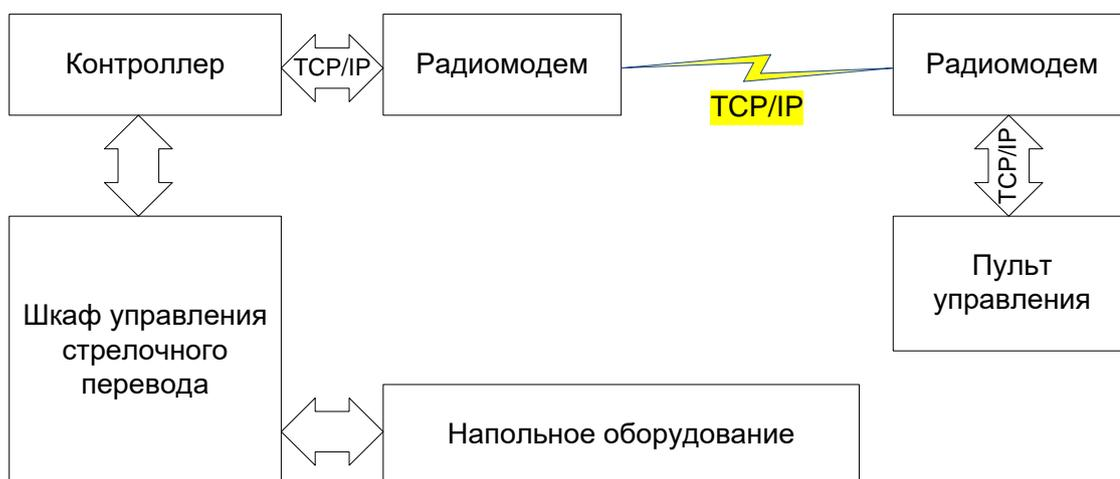
Рис. 1. Структурная схема дистанционного контроля и управления стрелочного перевода.
