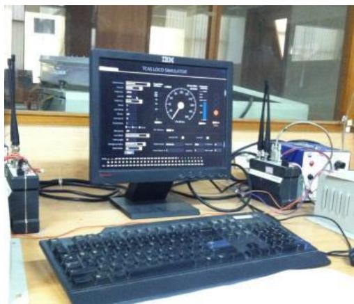
Рис. 2 Внешний вид рабочего макета бортового комплекса системы управления поездами индийских железных дорог на этапе внедрения.
