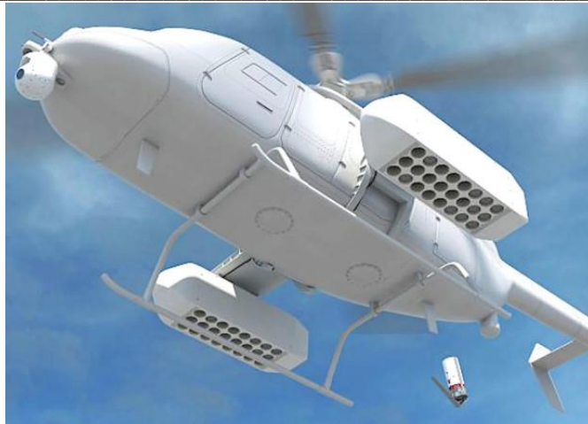
Американский БЛА MQ-8С с двумя контейнерами для гидроакустических буев ( https://nplus1.ru/news/2021/02/05/submarine ).
